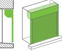
Coffre dans l'alignement de la façade. Pose entre les murs. Vérifier que l'épaisseur du coffre n'exécède pas l'épaisseur du mur extérieur.
