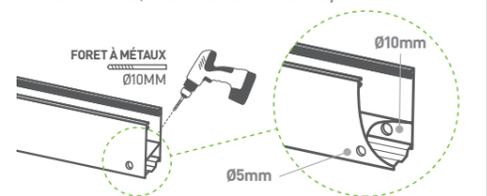
Présenter l'ensemble joue E et coulisser G à la maçonnerie, tracer les trous de fixation de la coulisser à l'aide d'un crayon. Retirer la coulisser, percer et insérer les chevilles.
