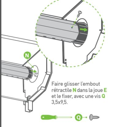
Faire glisser l'embout rétractile **N** dans la joue **E** et le fixer, avec une vis **Q** 3,5x9,5.
