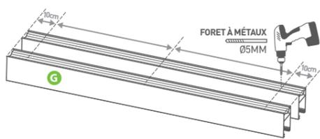
• Retourner les coulisser G et percer la première épaisseur avec un foret de Ø10mm afin de permettre le passage de la tête de vis, lors de la fixation à la maçonnerie.
