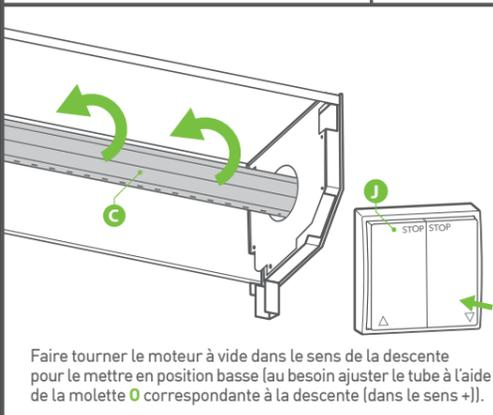
Faire tourner le moteur à vide dans le sens de la descente pour le mettre en position basse (au besoin ajuster le tube à l'aide de la molette **O** correspondante à la descente (dans le sens +)).
