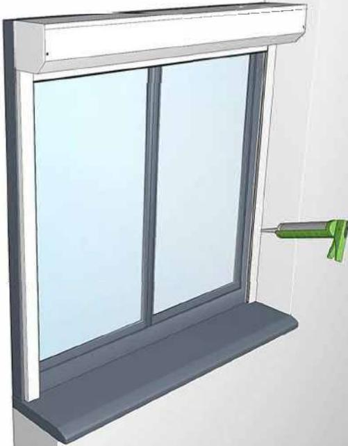
Si l'écart entre le mur et le volet roulant est trop important, appliquer un fond de joint en mousse.
