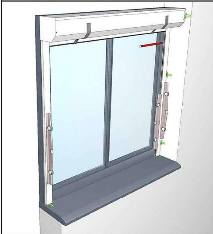
**8** Retirer le volet roulant afin de pouvoir percer et cheviller aux repères réalisés à l'étape précédente.
